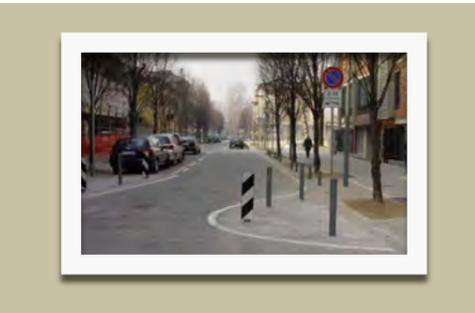
La sosta deve essere regolamentata e le aree di sosta individuate possibilmente al di fuori della piattaforma (ma allo stesso livello di questa): questi stalli, adibiti esclusivamente a parcheggio dei veicoli, devono essere pavimentati, necessariamente, con materiali o con colorazioni differenti rispetto a quelli utilizzati per la piattaforma.
